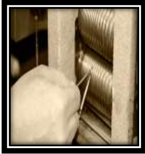
شكل رقم (٦) يوضح عملية السحب اليدوي باستخدام ماكينة الدرفلة
