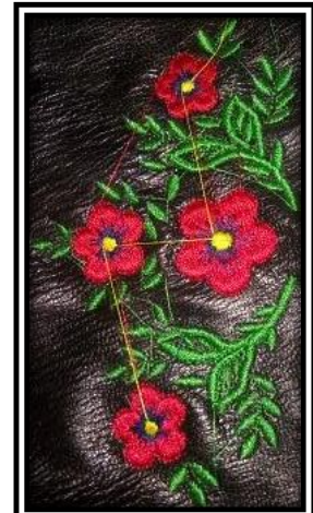
عينة رقم (١٠) جلد لباني كثافة الغرز: سميكة التقوية: فازلين
