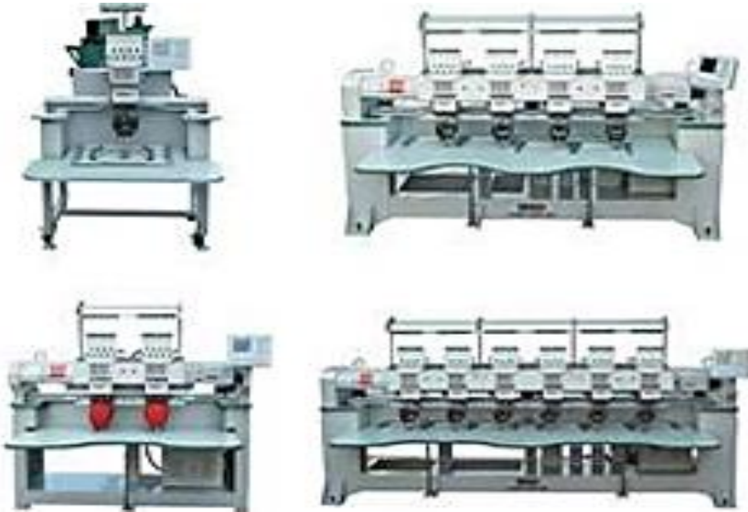
صورة رقم (٢) ماكينات التطريز الالكترونى ذات الرؤوس والإبر المتعددة ( https://qembroidery.com )
