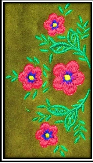
عينة رقم (٢٧) جلد شمواه كثافة الغرز: منخفضة التقوية: ورق
